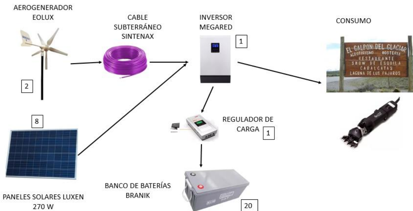
FIGURA 5: diagrama en bloques de la instalación.
