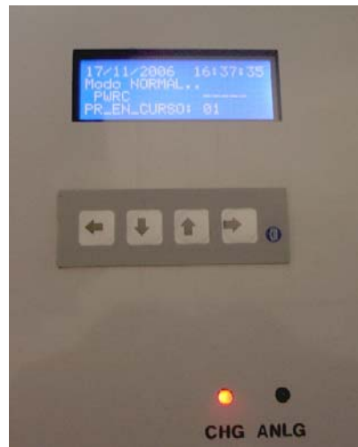
Figura 7.7 - Frente con Display 4x20 LCD y Teclado en Equipos similares a SISMEDH
