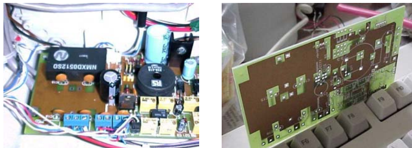
Figura 7.17 – Placa Powers3a en SISMED01/12 (izq), y placa básica sin componentes
