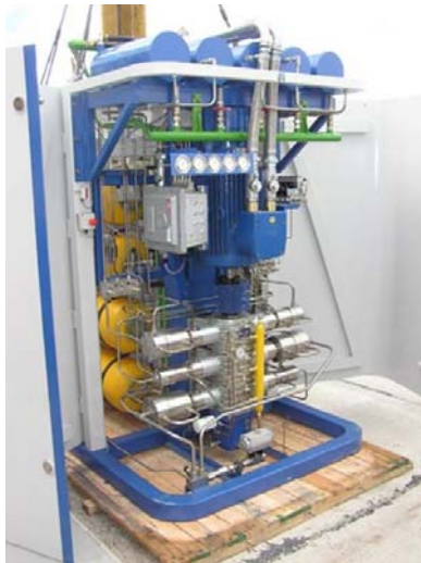
Figura 4.8a,b – Vista interior Compresor Galileo H2 (30kW) - Lanzamiento del Proyecto “Viento – Hidrógeno” Organización de las Naciones Unidas – Planta H2 Pico Truncado / Mayo de 2005
